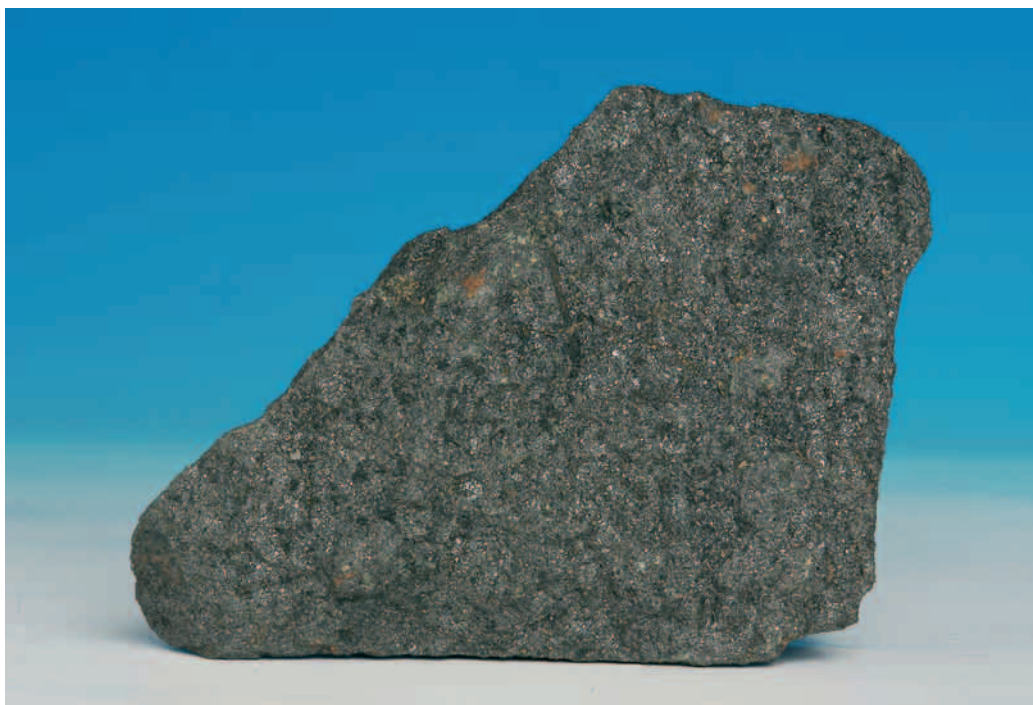
Ilmeniitti, Kälviä, Koivusaarenneva. Näytteessä on myös runsaasti magnetiittia, jota paljaalla silmällä ei pysty erottamaan ilmeniitistä. Näyte on Suomen Kivikeskuksen kokoelmassa, jonne se on lahjoitettu GTK:n Kivimuseosta. Paino 1310 g. Läpimitta 12,5 cm. Kuva: Jari Väättäinen, GTK.
